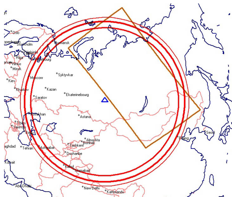
Рис. 1. Область обзора антенной системы приемной станции Центра космического мониторинга и прикладных геоинформационных технологий Томского государственного университета систем управления и радиоэлектроники
